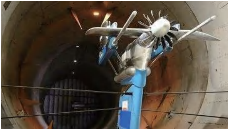
▲ 开式转子发动机风洞试验（图片来源：GE 航空航天公司）
