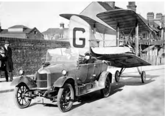
▲ “蛾” 的机翼可以折叠，一辆小车就能拉着跑
