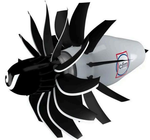
▲ 可持续发动机革命性技术验证项目（RISE）开放式风扇架构渲染图（图片来源：CFM 国际）
